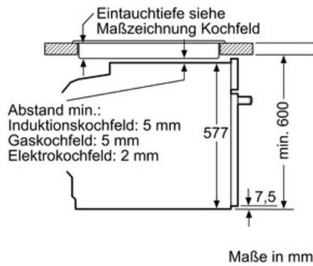
Wird das Gerät unter einem Kochfeld eingebaut, muss folgende Arbeitsplattenstärke (ggf. inkl. Unterkonstruktion) beachtet werden.
